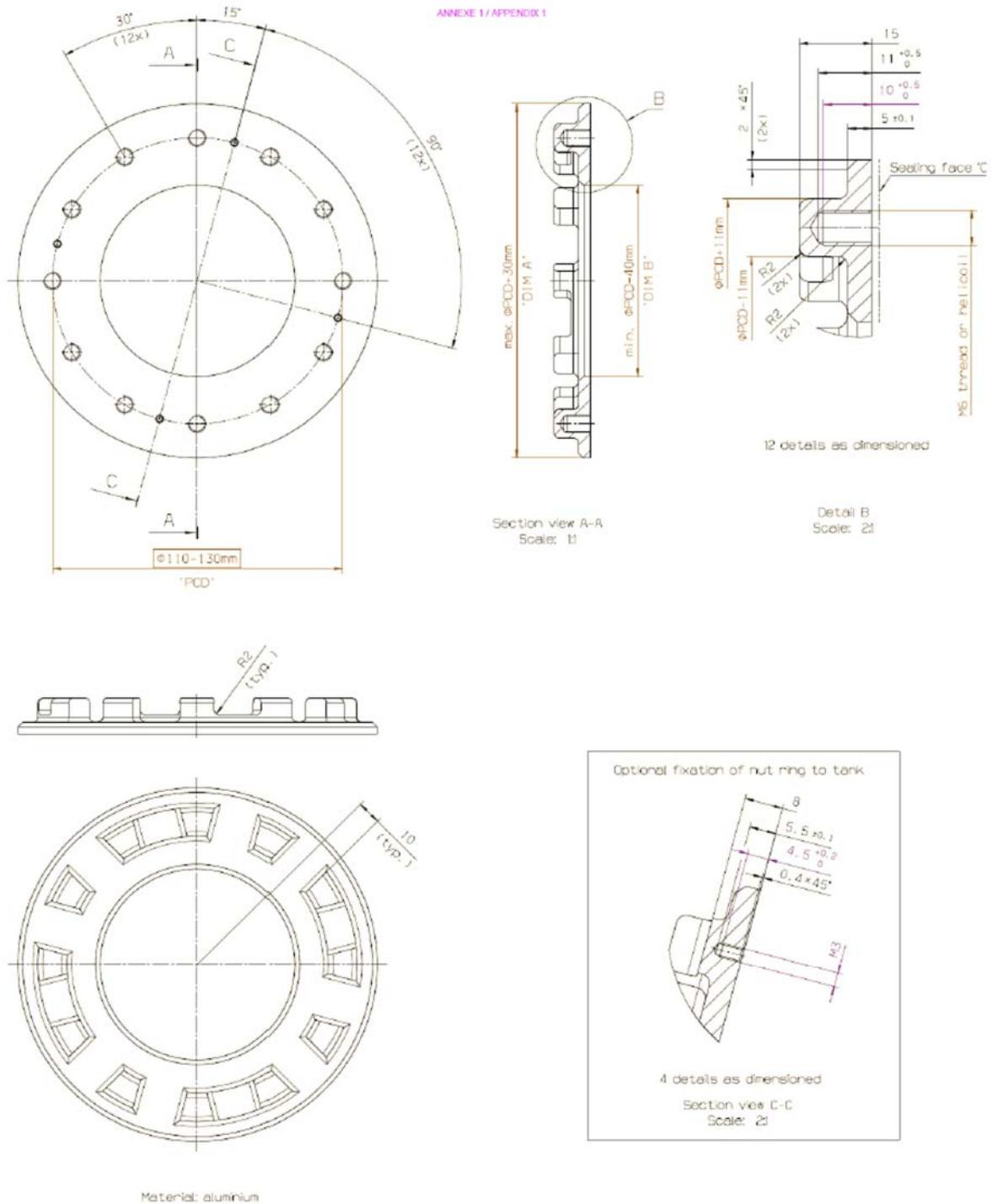
ナットリング 付則1、断面A-A スケール1 : 1、詳細B スケール2 : 1
