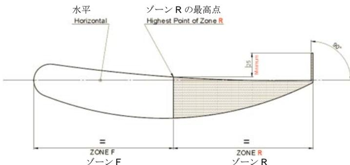
荷重は、最大幅 25 mm の適切なアダプターを経由して後端の頂点にか
